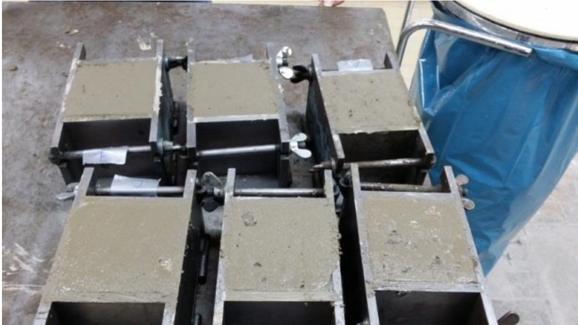
Figur 9: Tillverkning av betongkuber.
