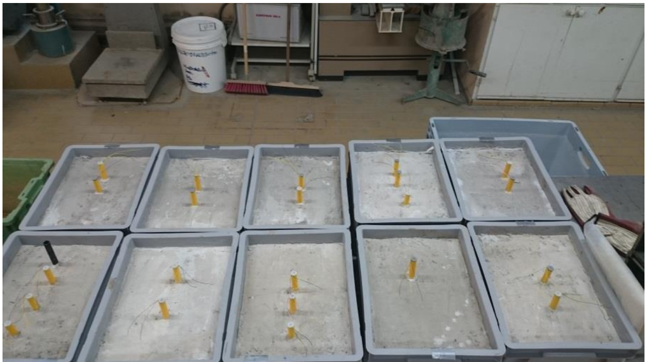
Figur 17: Torkad betong med monterade RF-givare
