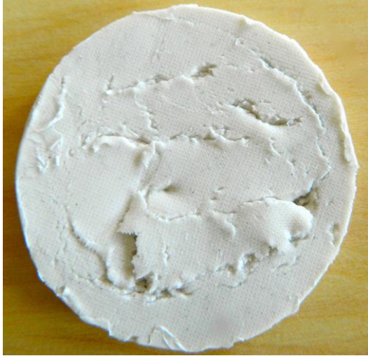
Bild 14. Förstörd silikonform från T4 textilen efter avformning.
