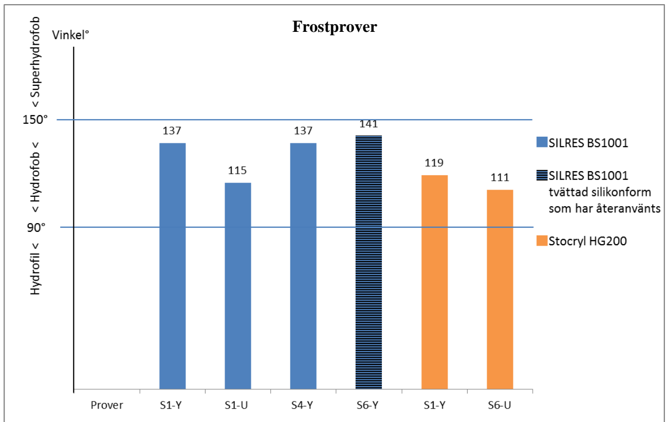
Diagram 11. Kontaktvinkelmätning för samtliga prover som är tagna ur olika gjutningstillfällen för frostprovning. S1-Y-STO och S6-U-STO har valts ut från tabell 12 för frostprovning. Resterande prover har valts ut från tabell 13. Mätningen utfördes 1 dag efter frostprovning.
