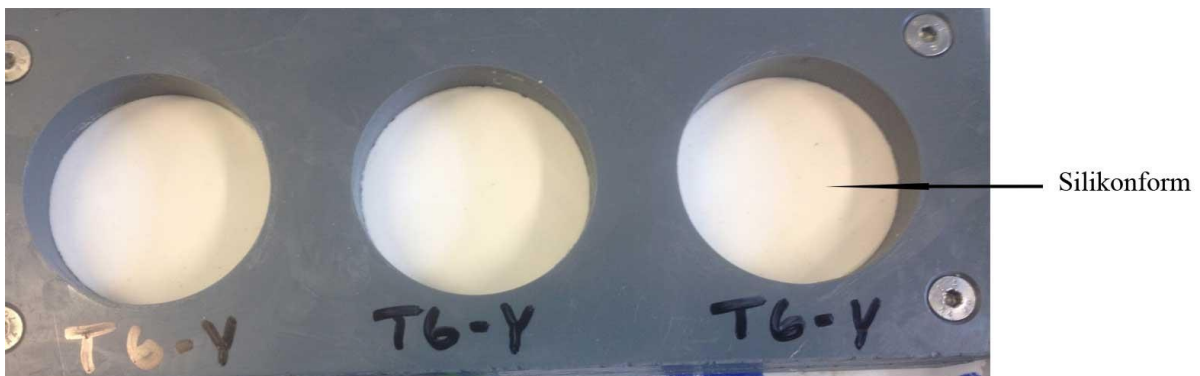
Bild 7. Silikonformen härdad på T6 textilen.
