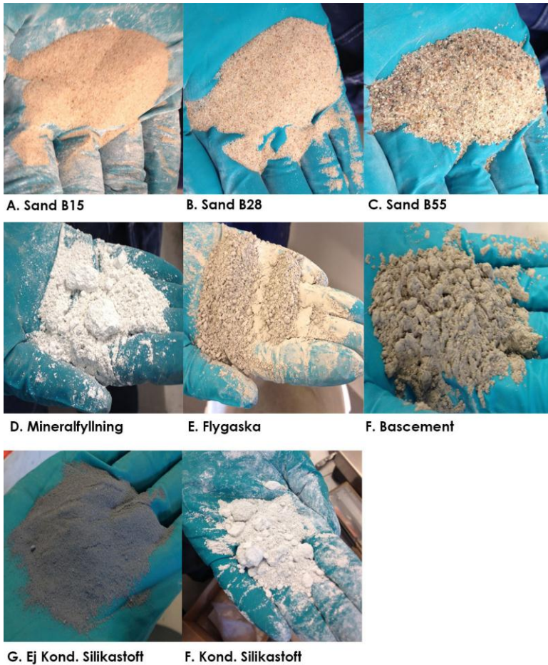
Bild 4. Torra komponenter som använts, varav G och F i separat blandning.
