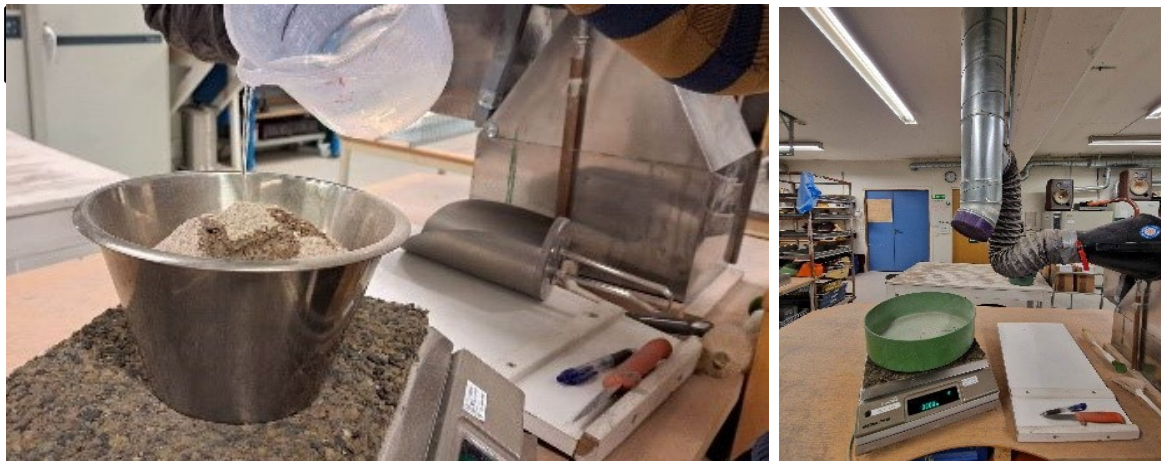
Figur 9 1. Hällning av vatten till önskad fuktkvot, 2.materialvägning
