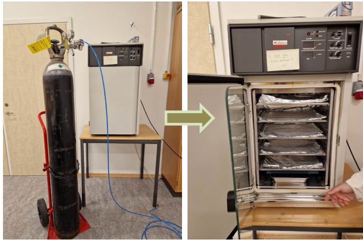
Figur 8 Karbonatisering av CCA, till vänster är koldioxid gas som är kopplad till koldioxid tillsättningsmaskinen. På skåpet där läggs vatten på botten och CCA ovanpå.
