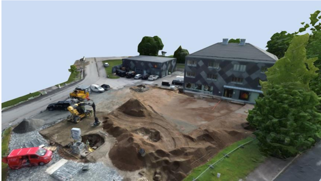
Figur 4. Skalenlig 3D-modell av ett byggprojekt utfört med drönbaserad fotogrammetri. Återgiven med tillåtelse från T3 Group.
