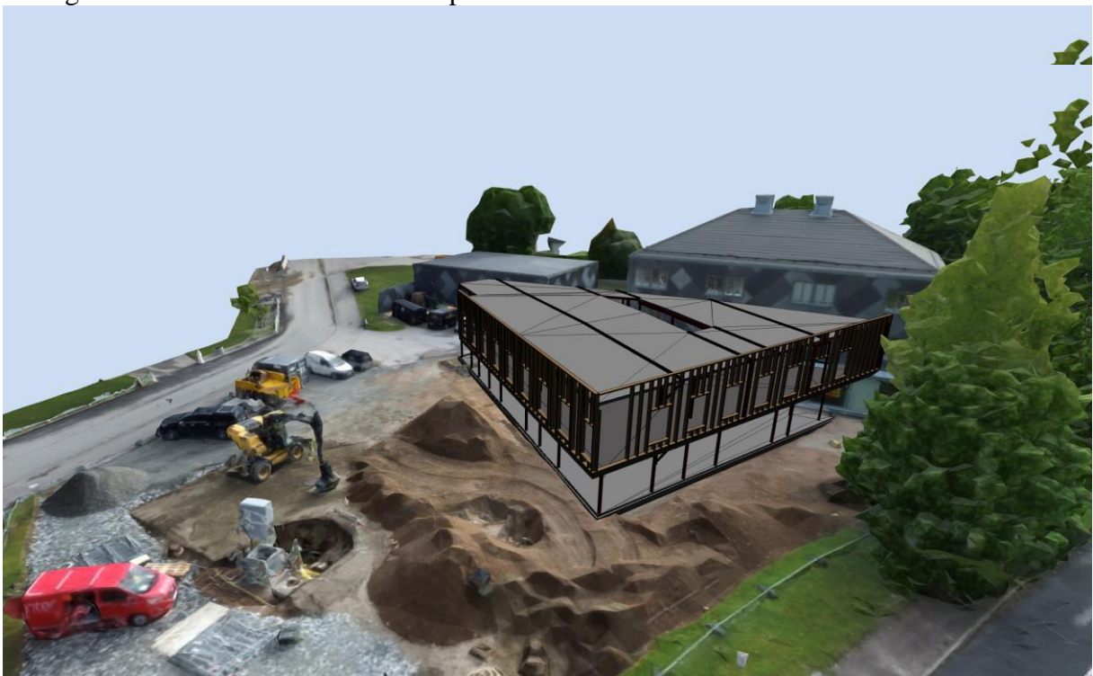
Skalenlig 3D-modell av ett byggprojekt utfört med drönbaserad fotogrammetri. Bild återgiven med tillåtelse från T3 Group.
