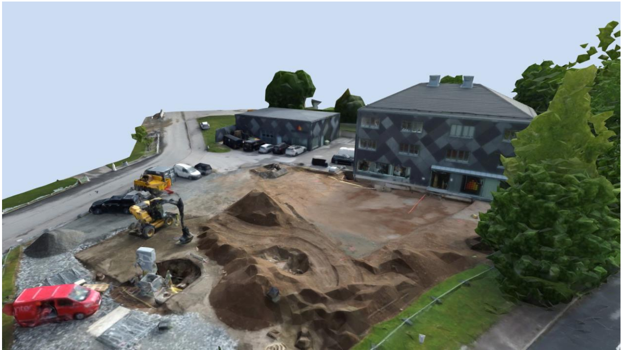
Skalenlig 3D-modell av ett byggprojekt utfört med drönbaserad fotogrammetri. Bild återgiven med tillåtelse från T3 Group.
