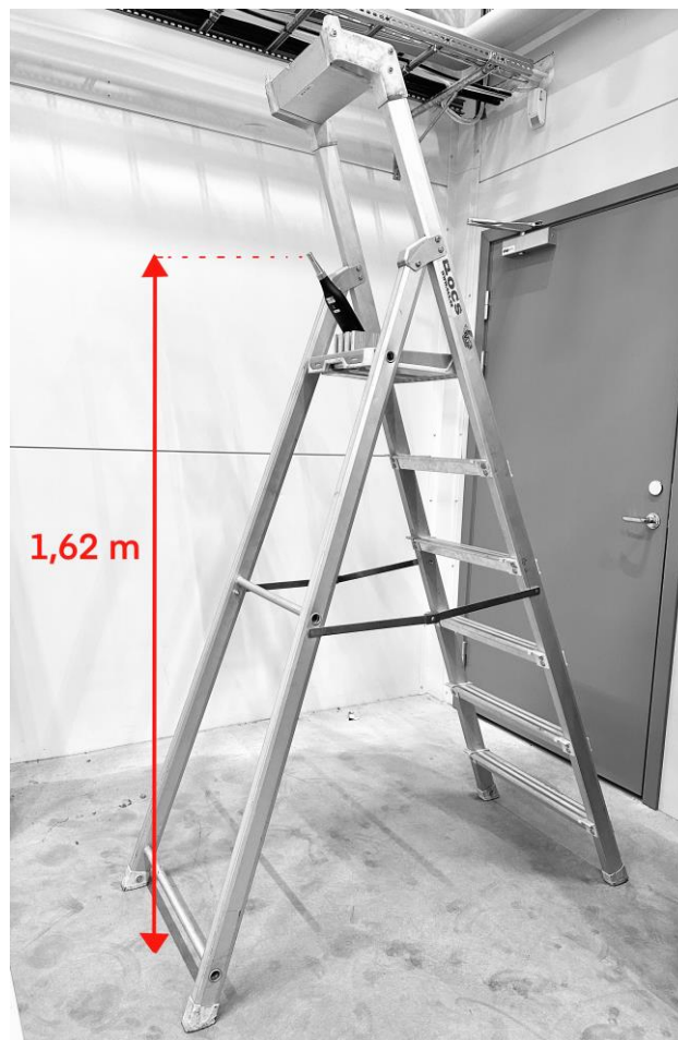
Figur 9: Uppställning av mikrofonposition
