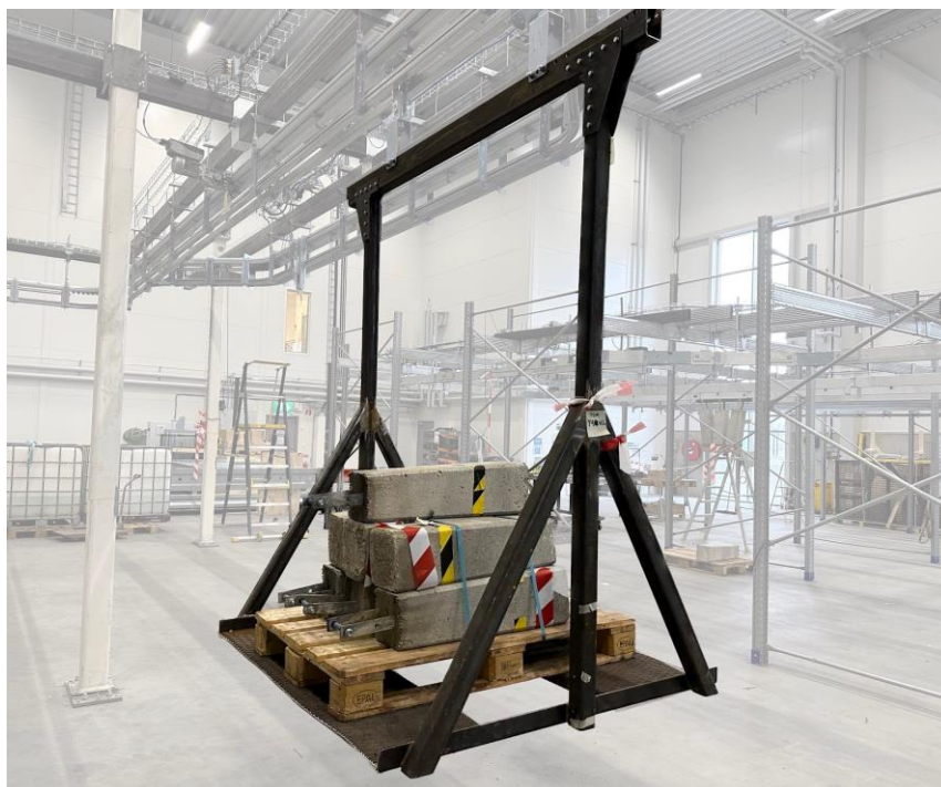
Figur 7: Produktbärare för OCS-500 med monterad last på 500kg
