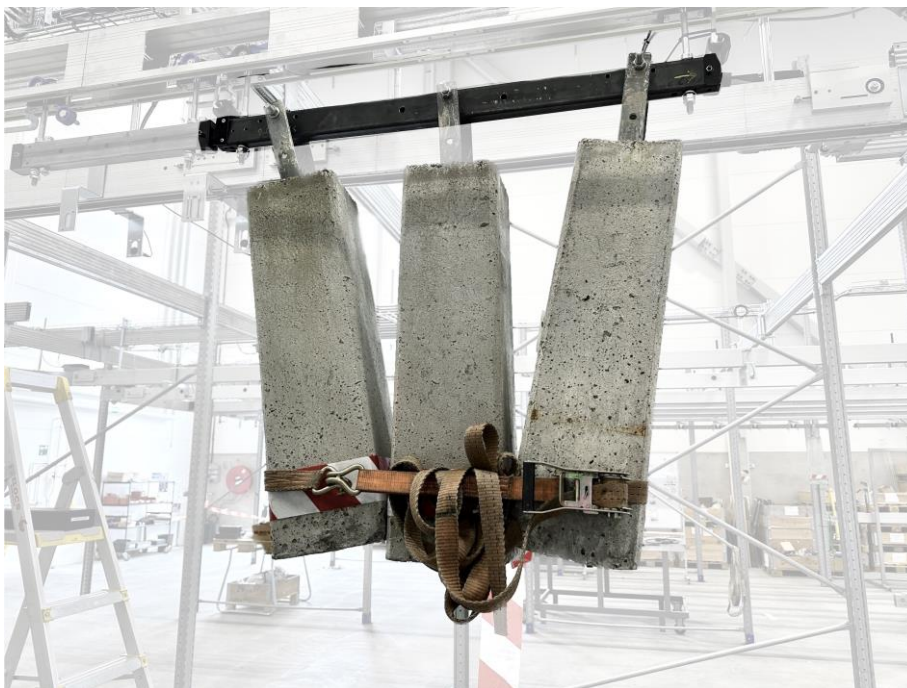
Figur 6: Produktbärare för OCS-150 med monterad last på 150kg
