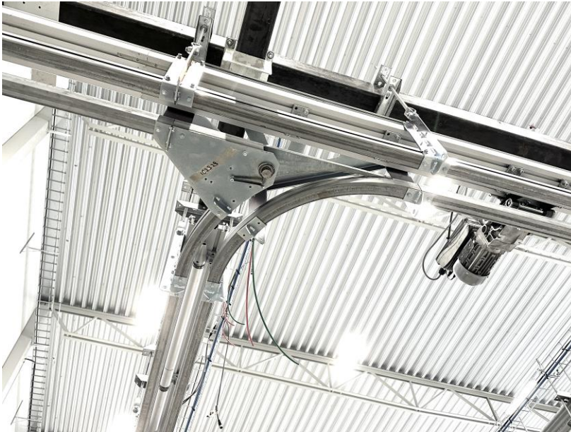
Figur 20: Kurva för OCS-500. Orsakande faktor för ökad ljudemission
