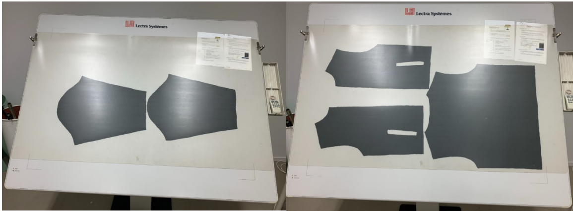
Figur 3 Gruppering av mönsterdelar för storlek 3XL. Vänster: ärmar. Höger: framstycken och bakstycke.
