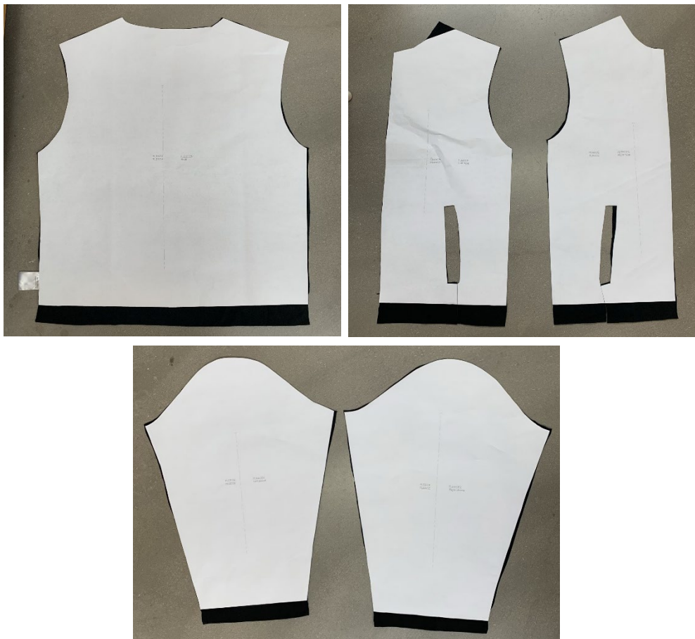
Figur 4 Kontroll av hur korrekt inskanning av mönsterdelar stämmer överens med de verkliga delarna. Från vänster till höger: Bakstycke, framstycken och ärmar.
