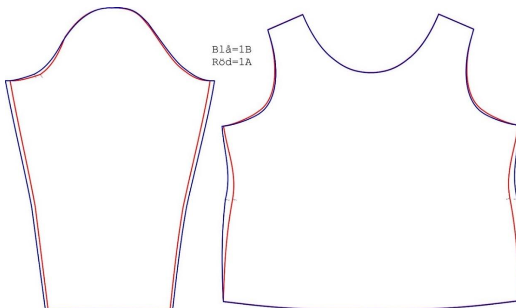
Figur 5 Mönsterjämförelse av framstycke och ärm för modell 1, storlek XXL (blå= procentuell rörelsevidd, röd = proportionell gradering)
