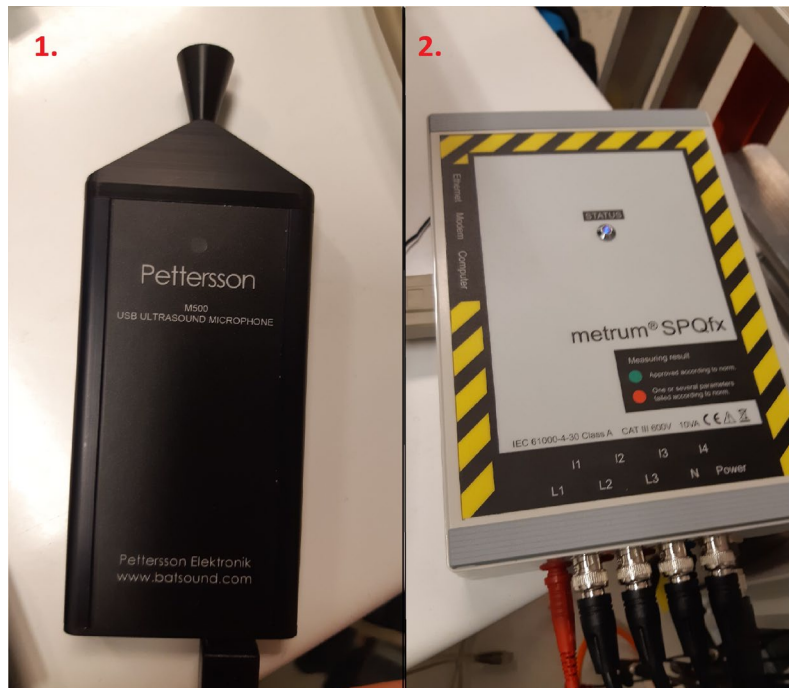
Figur 3.1. Petterssons ultraljudsmikrofon M500 (1) och metrums nätanalysator SPQfx (2).
