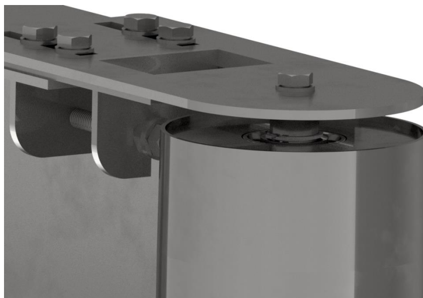
Figur 49 – Montering av vändtrumma och spårring
