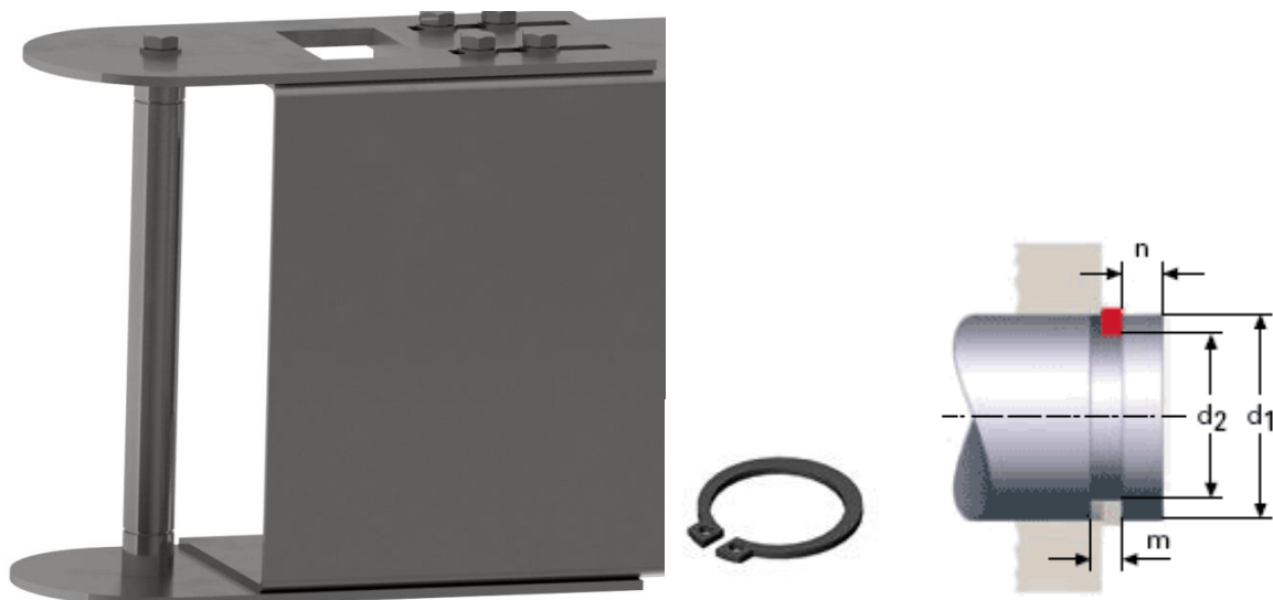
Figur 48 – Infästning av axel vändsida samt spårring av fabrikat Lesjöfors
