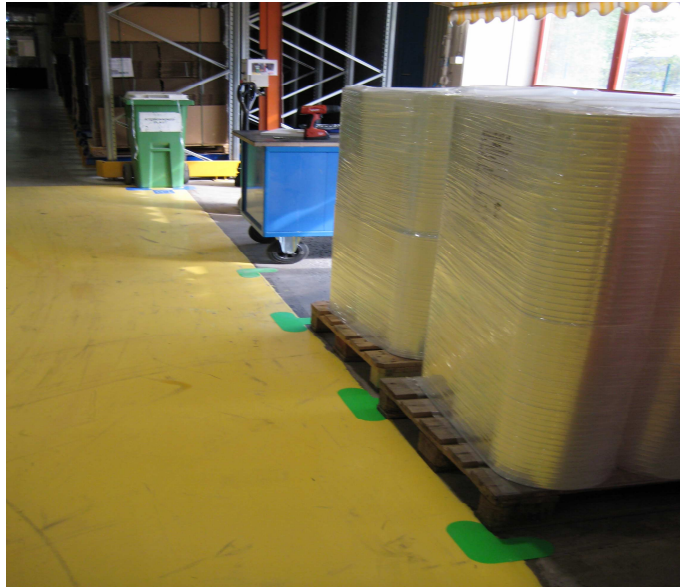
Figur 6.2: Golvmarkeringar placerades ut för att skapa ordning och reda samt visualisera flödet.
