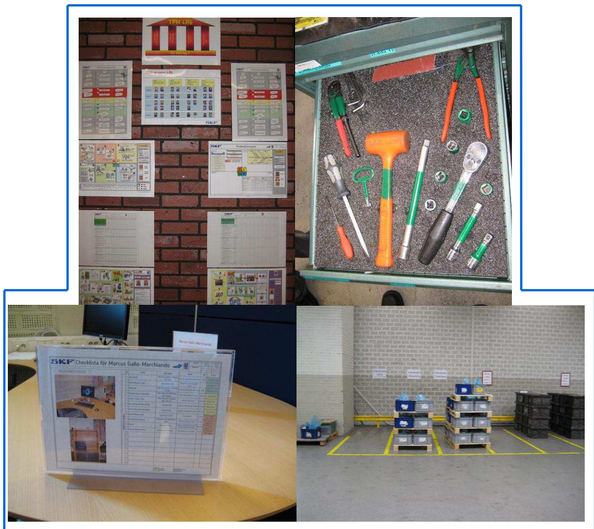
Figur 4.1: Några bilder från Industri divisionen på SKF. ÖV: Tavla vid en maskingrupp med aktuell information om TPM, förbättringsprojekt och omställningar. ÖH: Till varje låda hade skumgummi skärts ut för att visualisera varje verktygsposition. UV: Rutiner för kontor. UH: Golvmarkeringar och beskrivningar.
