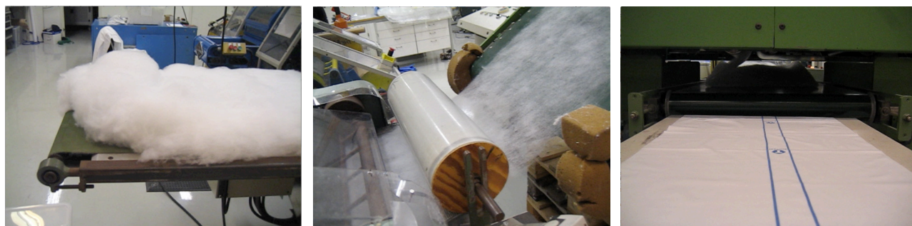
Figur 8 Delar av processflöde vid nålning. Flor före och efter andra kardning. Väv förs in i korsläggare där flor viks ner på väv ovanifrån.
