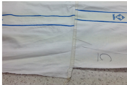
Figur 6 Färdig söm vid sammanfogning av lakan.
