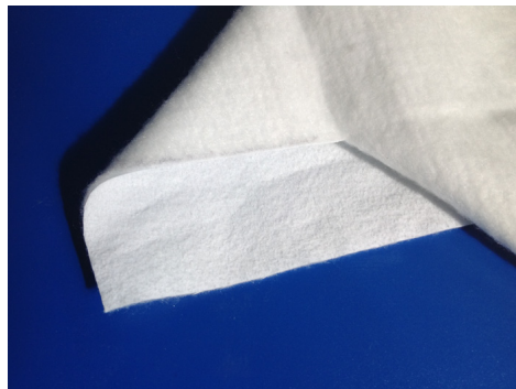
Figur 12 Prepreg; fibrer i bi-komponent nålat tillsammans med lakansväv.
