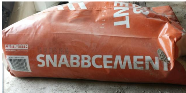
Figur 21 Snabbcement används vid alla gjuttillfällen kombinerad med flyttillsats.
