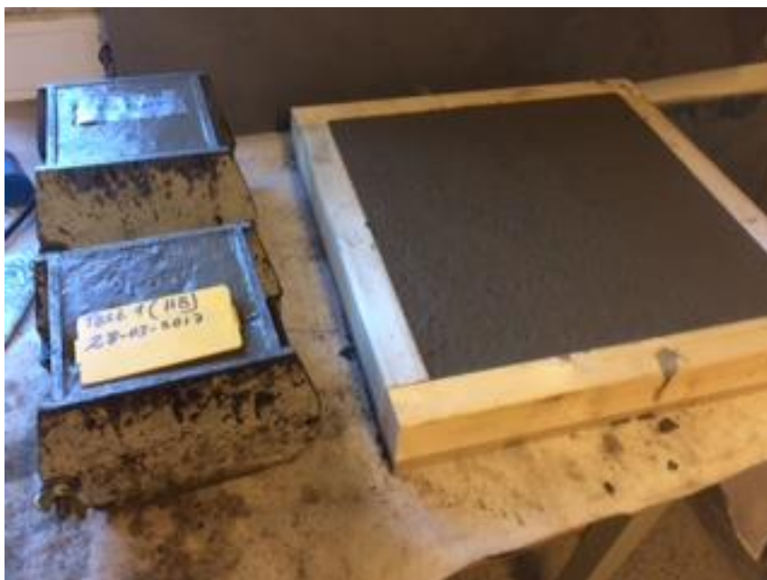
Figur 17 En gjutform fylls med betong för att undersöka betongens bearbetbarhet.
