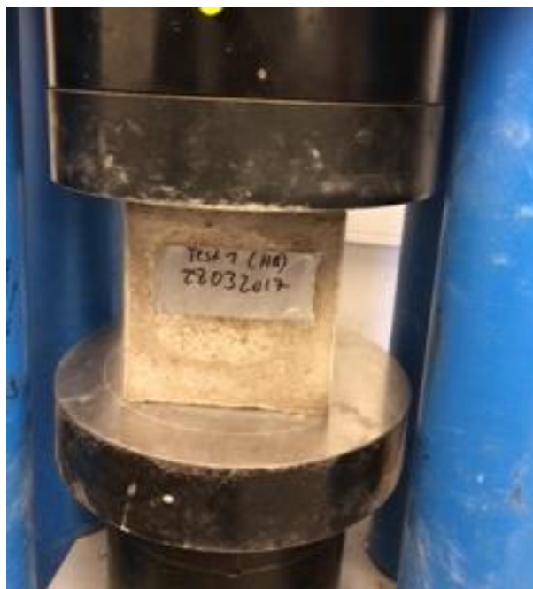
Figur18 Betongkuben centreras på provtryckmaskinens platta.
