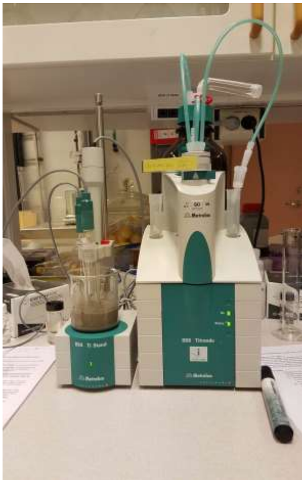
Figur 1: Titrerutrustning för att hålla och avläsa pH under lakningen.
