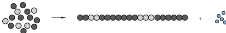
Figur 2. (a) Sampolymerisation där monomerer reagerar genom kondensationsreaktioner och bildar en polymer. Ett lågmolekylärt ämne, exempelvis vatten, avspaltas.
