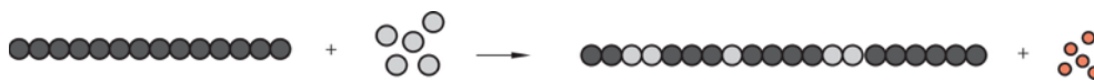
Figur 3. (b) Omförestring mellan polymer och monomerer. Sampolymer bildas under avspaltning av lågmolekylärt ämne.
