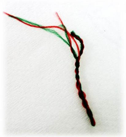
FIGUR 1 PROV I EXPERIMENT BESTÅENDE AV EN POLYAMID- RESPEKTIVE POLYESTERTRÅD
